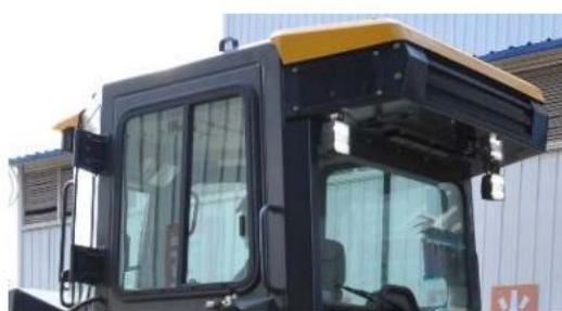
Vier leistungsstarke Halogen-Arbeitsscheinwerfer vorne und zwei hinten sind hoch positioniert, um eine hervorragende Beleuchtung von fast 360 Grad zu erzielen und Ihren Arbeitstag über das Tageslicht hinaus zu verlängern.
