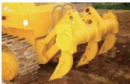
Mit dem aggressiven Parallelogramm-Aufreißer mit drei Zinken können Sie produktivere Aufreißerarbeiten erledigen. Das parallele Gestängedesign bietet eine bessere Durchdringung und Manövriertfähigkeit in engen Arbeitsbereichen.
