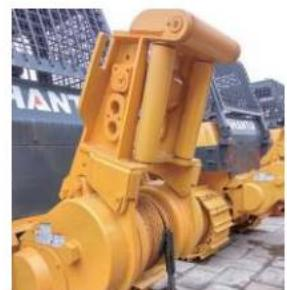
Die hydrostatische Winde kann zur Selbstrettung, Bergung von Ausrüstung, zum Holzfällen oder anderen Manövern verwendet werden. Die hydrostatische Winde von SHANTUI zeichnet sich durch hervorragenden Seilzug bei jeder Geschwindigkeit und eine stufenlos regelbare Trommeldrehzahl aus.
