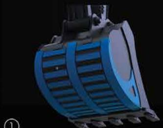
① Langlebigere Verschleißschutzplatten (Hardoxy 450 HB)
