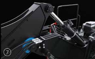
⑦ Verstärktes Auslegerzylinder - Gusslager
